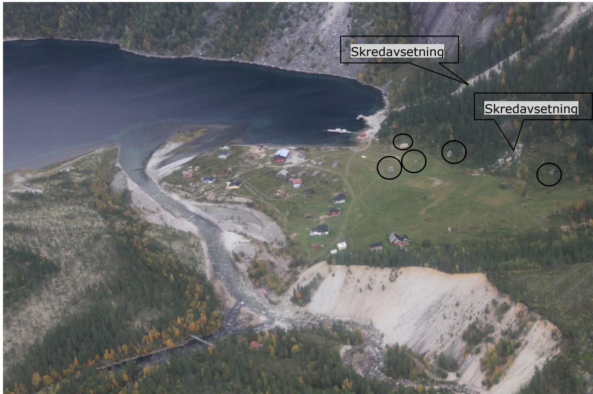
Figur 19: Foto av Hellmobotn. Steinsprangblokker og spor etter aktivitet i skredvifa er synlig. Kilde: Facebook
